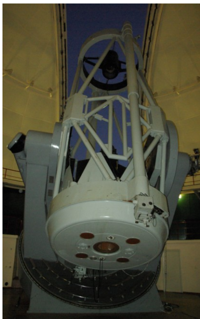
Z lewej teleskop Szajna o średnicy obiektywu 2.6 m, z prawej Agnieszka Debudej przy celostacie teleskopu słonecznego. (Fot. B.Wszolek)
