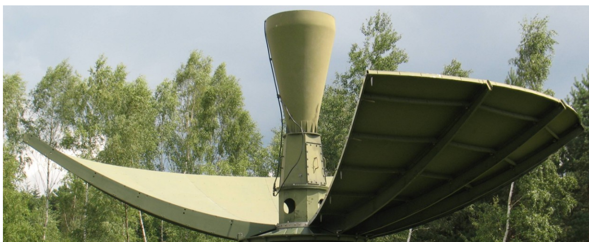
Zamocowanych 12 paneli czaszy.
