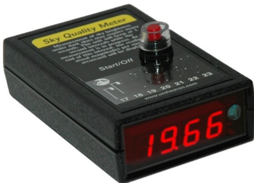
Rys. 1. Miernik Unihedron SQM. Za zieloną szczeliną po prawej znajduje się dioda światłoczuła. W wersji SQM-L miernika w tym miejscu jest też soczewka.
