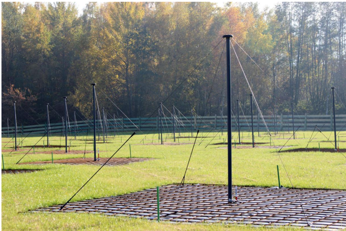
LOFAR – Łazy. Anteny LBA (Low Band Antennas) działające w niższym paśmie 90-110 MHz. (Fot. M. Soida)
