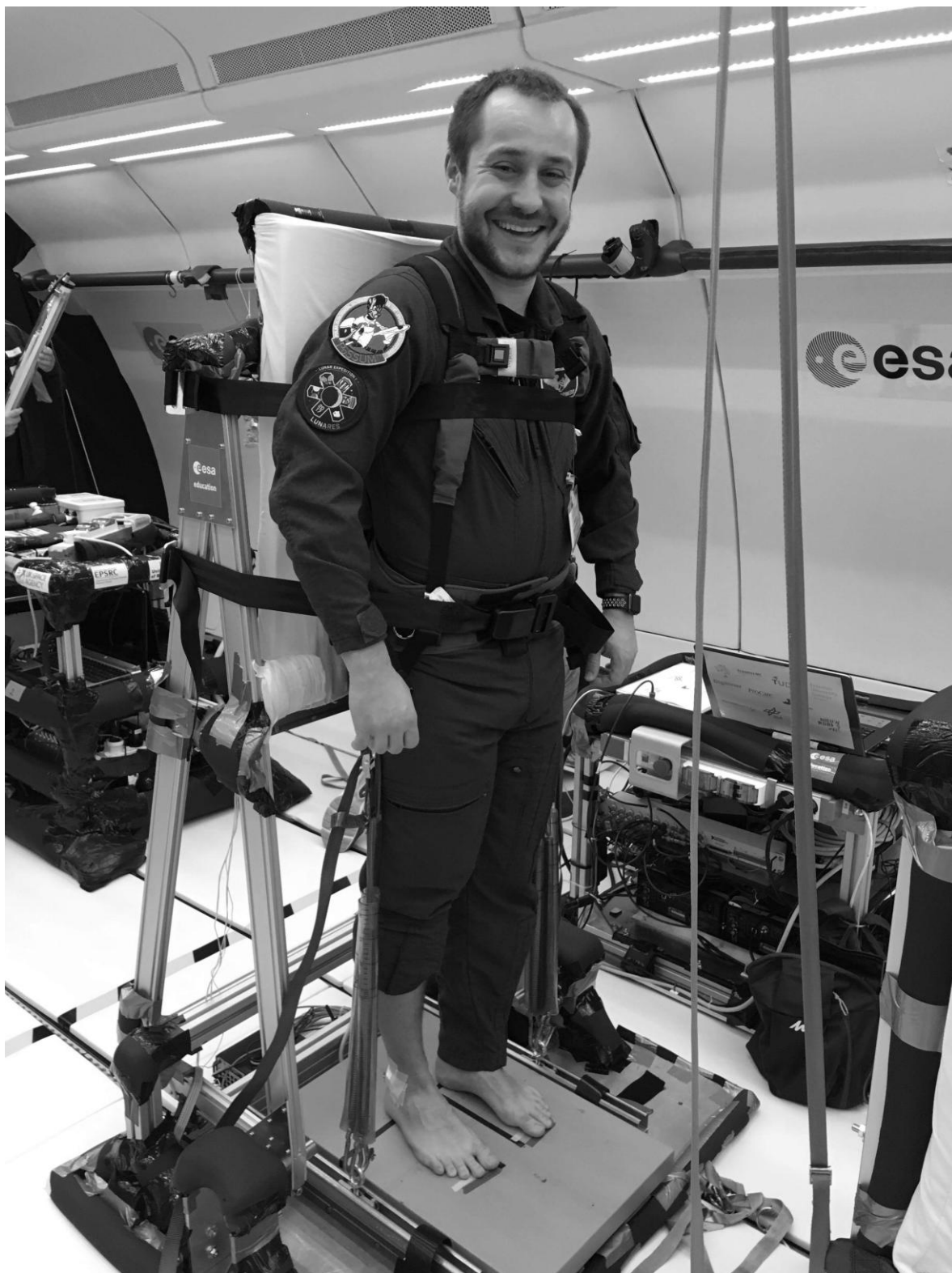
Mateusz Harasymczuk (Matt) przygotowany do pierwszego eksperymentu, w którym mierzone było napięcie mięśniowe nóg podczas stymulacji prądem o przebiegu kwadratowym w stanach 1.8g - 0.0g - 1.8g - 1.0g .
